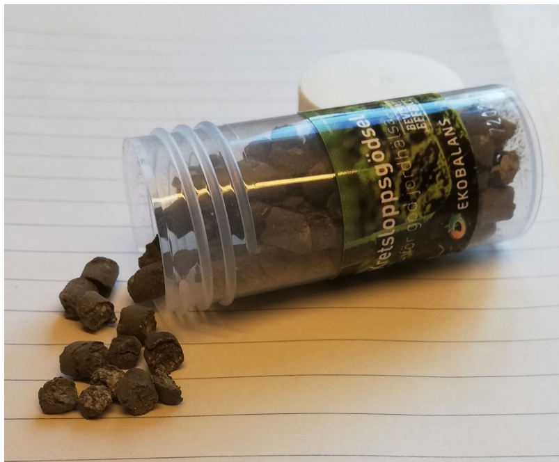
Bild 1. H+ en pelleterad kretsloppsgödsel framtagen av Ekobalans. Pelleten bestod av ca 50% organisk fraktion och ca 50% återvunnen mineralfraktion (främst ammoniumsulfat).
